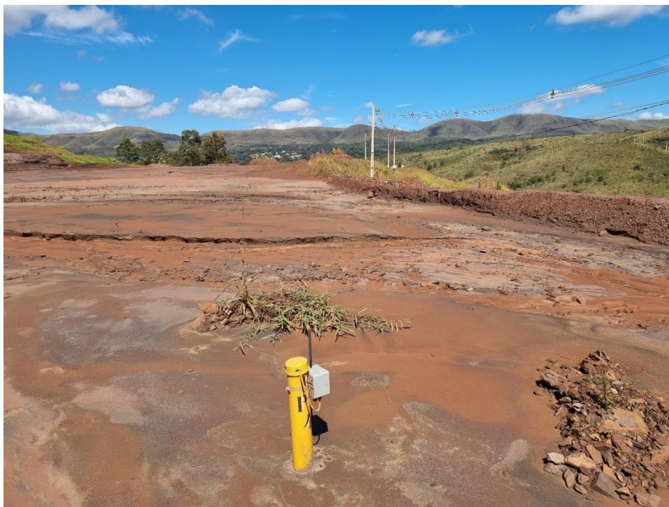
FOTO 23 – Instrumento B1PZC47, instalado na porção central da estrutura, automatizado e acompanhado em tempo real.
