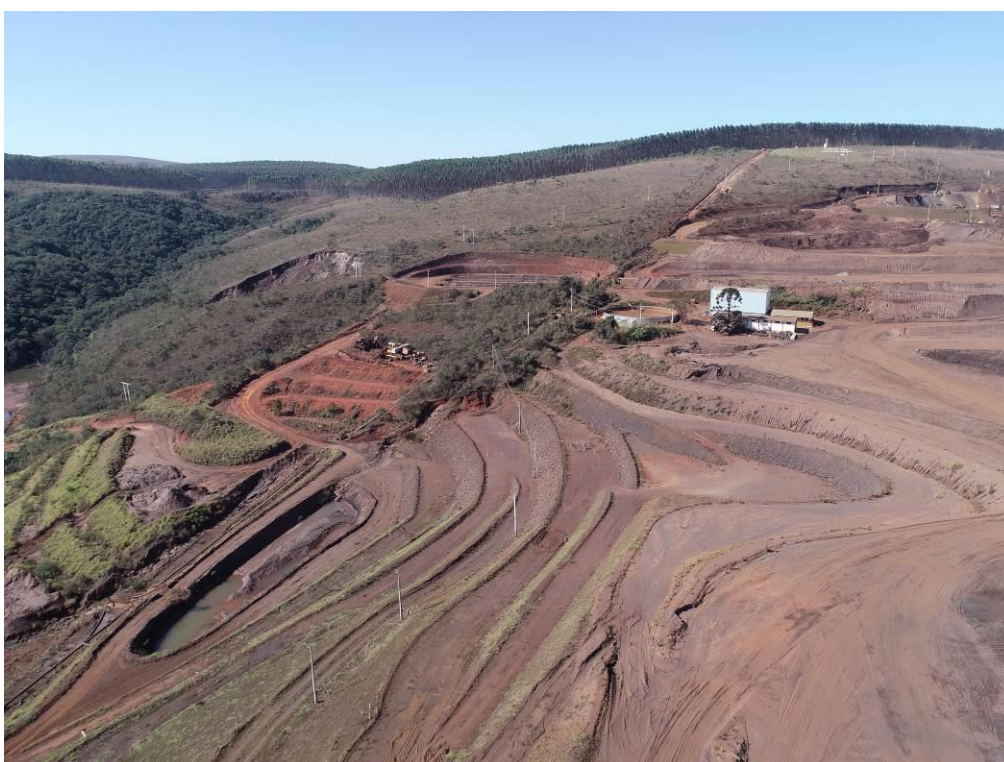
Região acidentada em 2014, objeto de reforço com enrocamento em itabirito e geometrização dos taludes.
