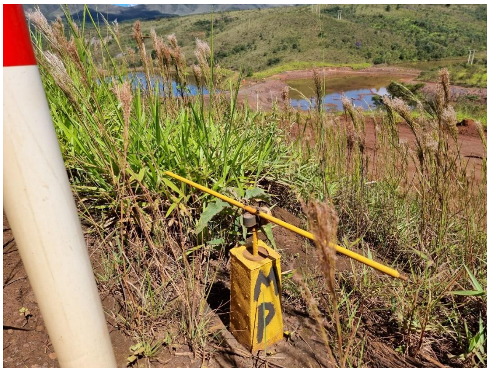
FOTO 30 – Detalhe de miniprisma utilizado na verificação de deformações na estrutura. Seu monitoramento vem evidenciando a inexistência de deslocamentos, considerando-se o limite de precisão dos equipamentos.
