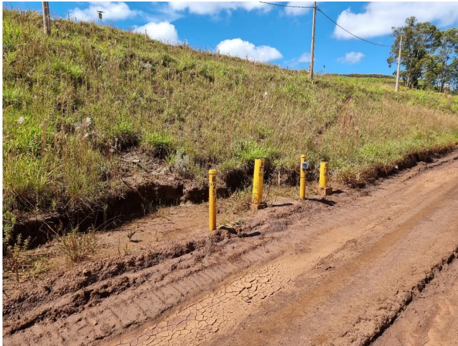
FOTO 33 – Detalhe dos instrumentos B1PzC04a, B1PzC04b, B1PzC53, B1PzC54, em parte automatizados.
