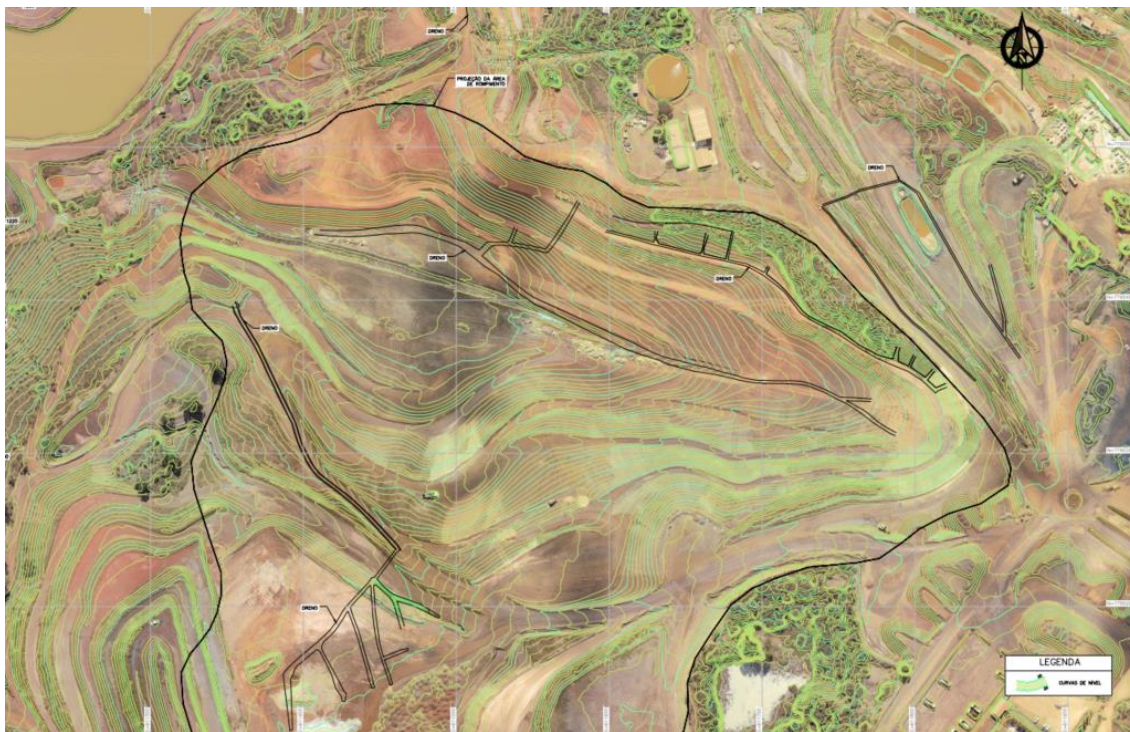
Figura 6 - Representação dos drenos instalados na região da Barragem B1 segundo cadastro realizado pela Herculano Mineração.
